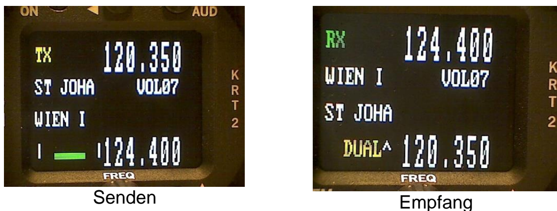
Figur 10: KRT2 TX & RX Betrieb
