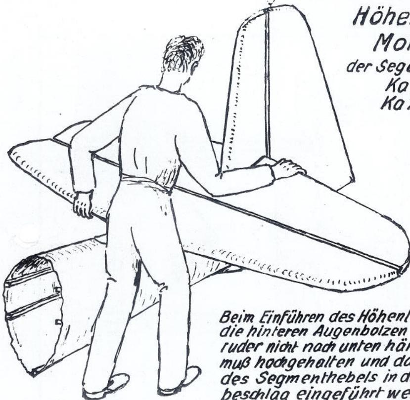
Beim Einführen des Höhenleitwerkes in die hinteren Augenbolzen darf das Höhenruder nicht nach unten hängen, sondern muß hochgehalten und das Kugellager des Segmenthebels in den U-Führungsbeschlagn eingeführt werden!
